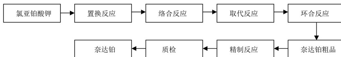
①置换反应阶段。针对文献方法所制得的产品纯度不高，在放置过程中不稳定、颜色加深、不良物质上升的问题，公司进行了多角度分析研究，运用自主研发的专利技术“一种含银量极低的奈达铂的制备方法”（专利号：200710020343.4），对奈达铂中的含银量进行严格控制，使制得的奈达铂中几乎不含银，产品纯度高、杂质含量低、质量稳定，降低了毒副反应，从源头上提升了注射用奈达铂的产品质量。
